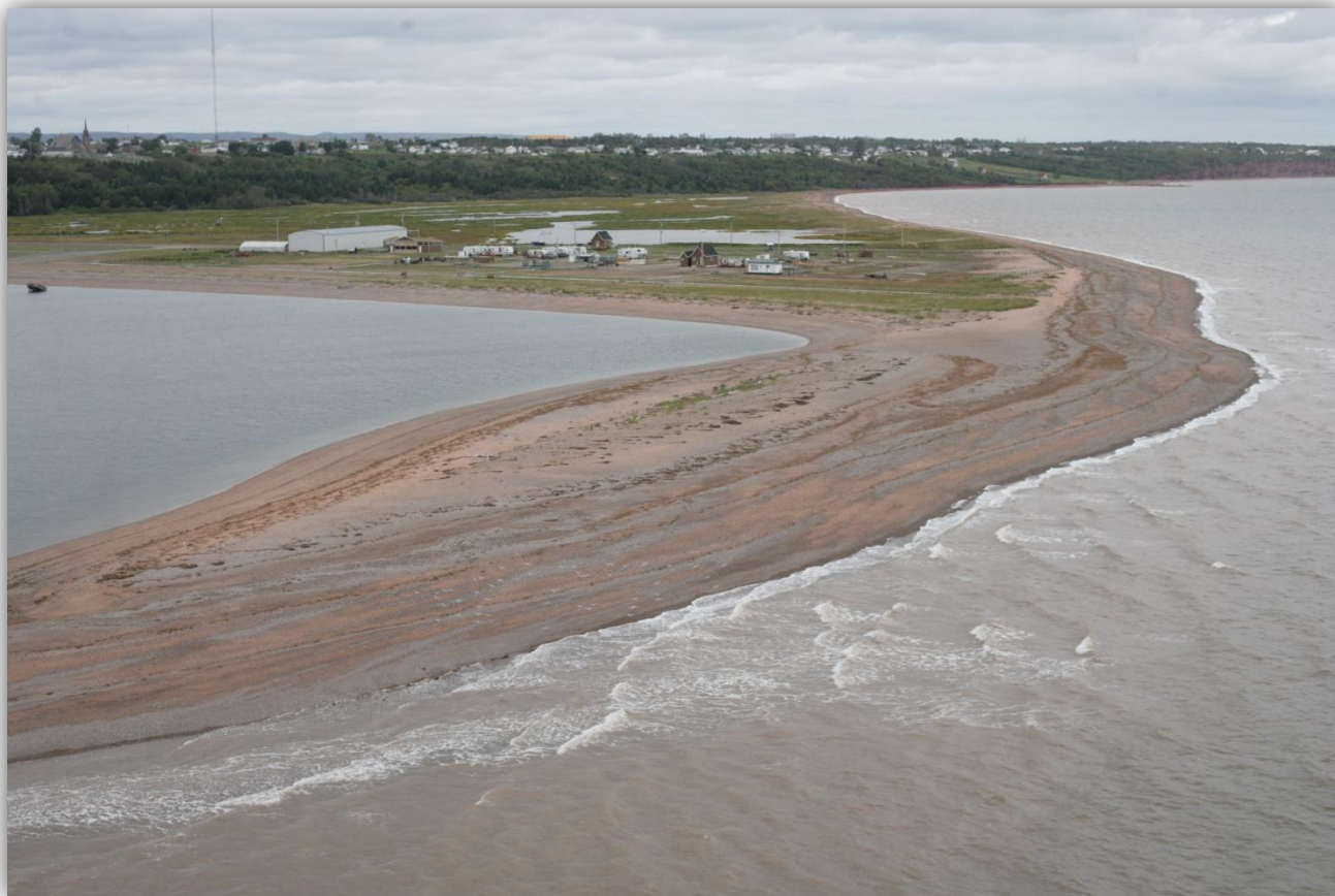
Figure 13. Érosion du barachois de Paspébiac et prolongement de la flèche littorale vers l'ouest
