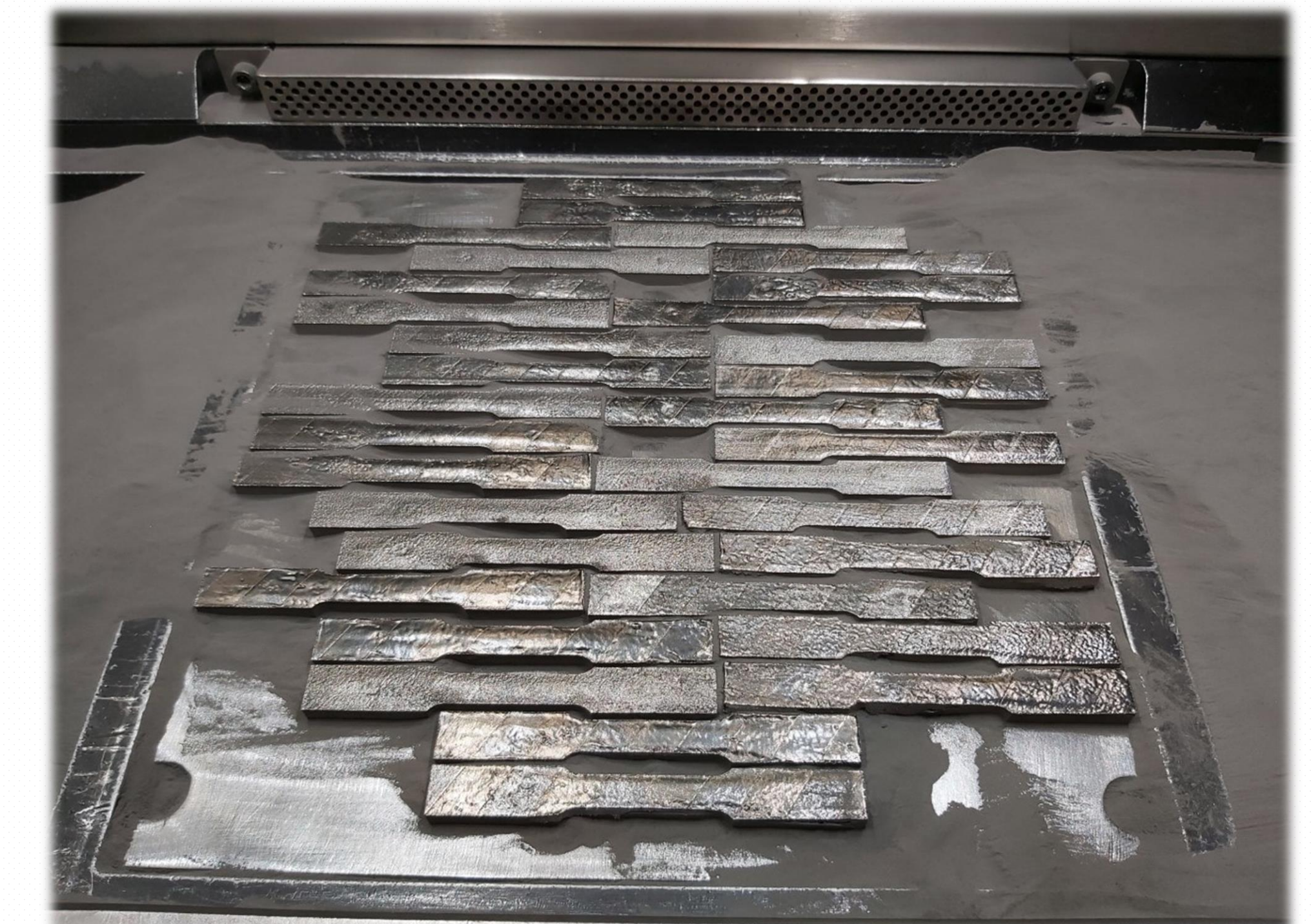
Figure 4 : Acier imprimé en 3D, résultat de la première phase de l'étude
