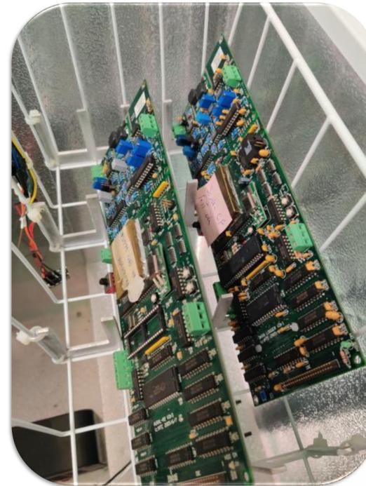
Figure 3: Exemple de dispositions des circuits imprimés dans le système de cyclage thermique
