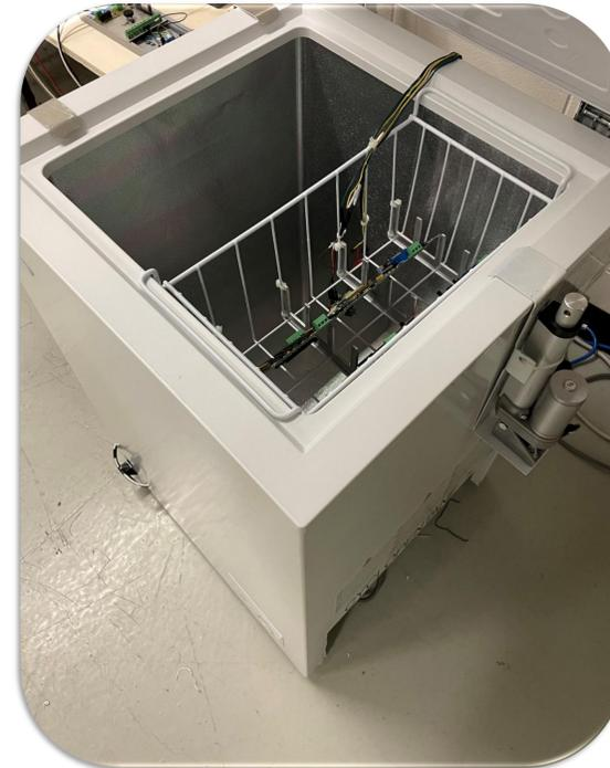
Figure 2: Vue du système de cyclage thermique avec l'actuateur (droite de l'image) et le support à circuits imprimés
