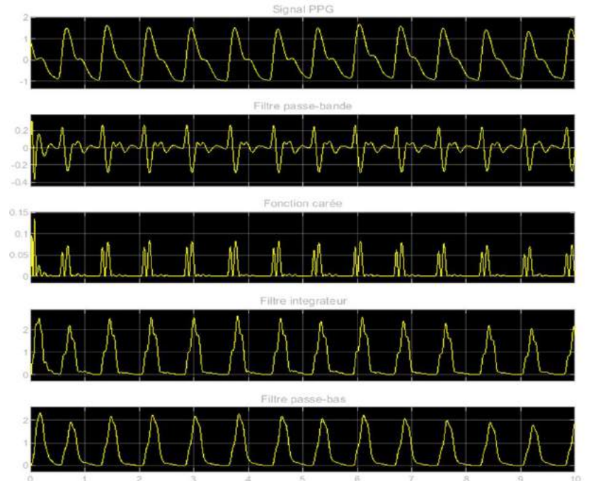
Prétraitement du signal PPG
