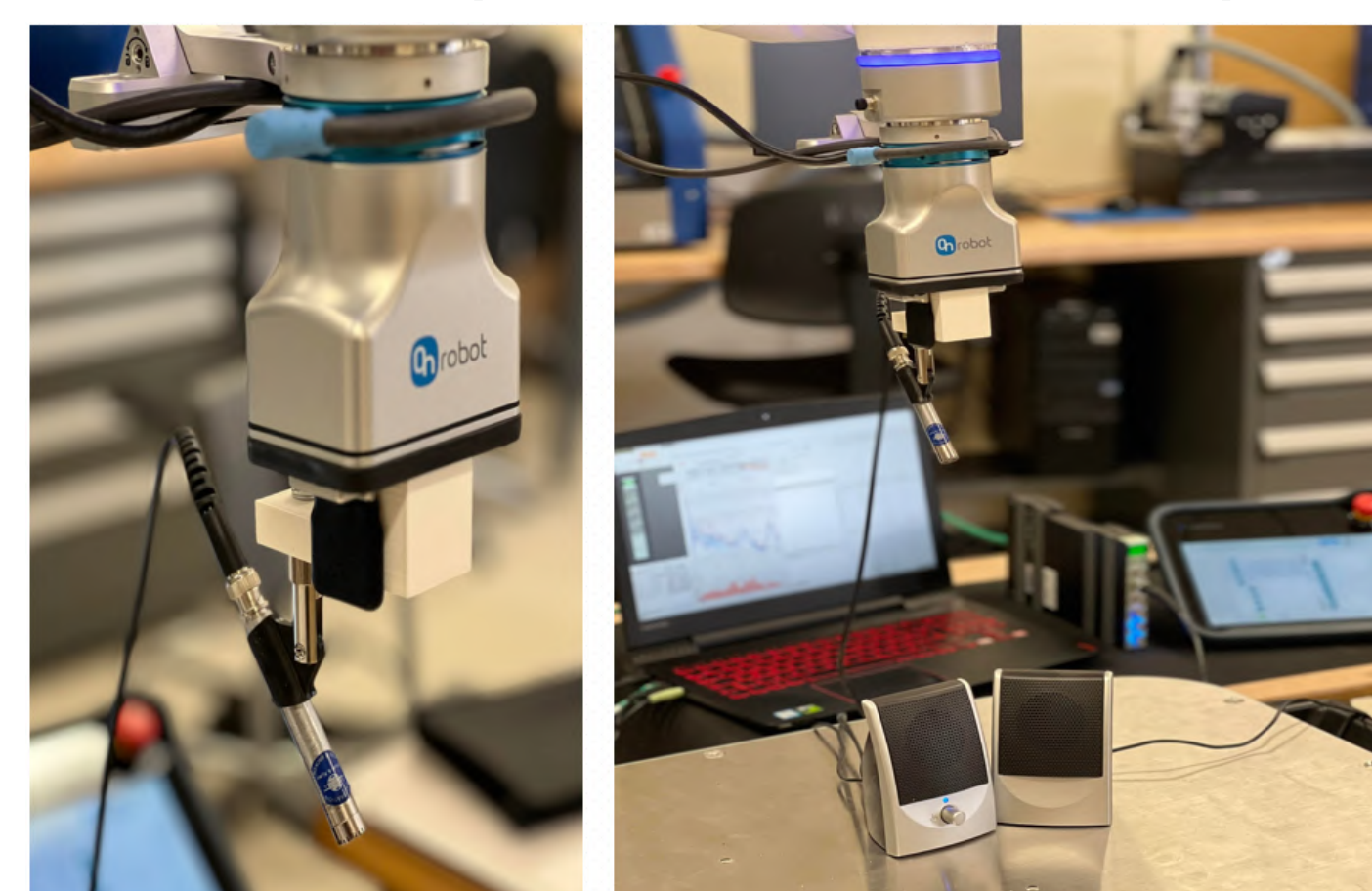
FIGURE 5 – Robot Doosan équipé d'un microphone qui suit un trajectoire bien définis
