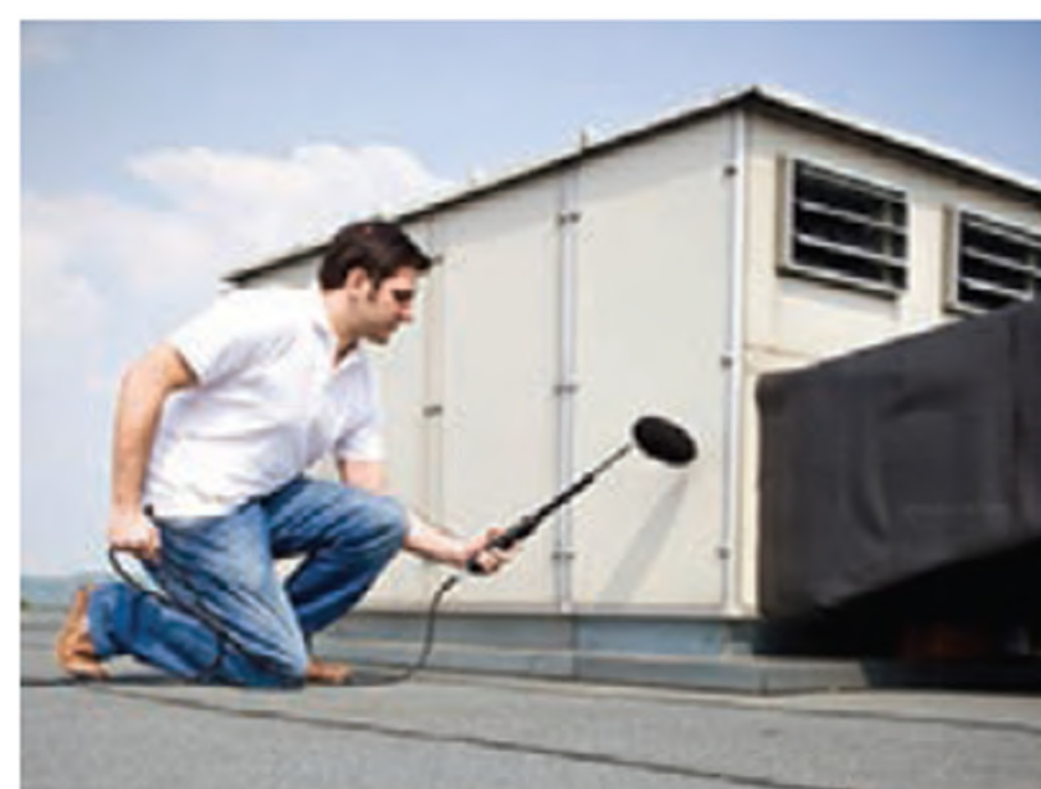
FIGURE 1 – Mesure manuelle de l'intensité acoustique[1].
