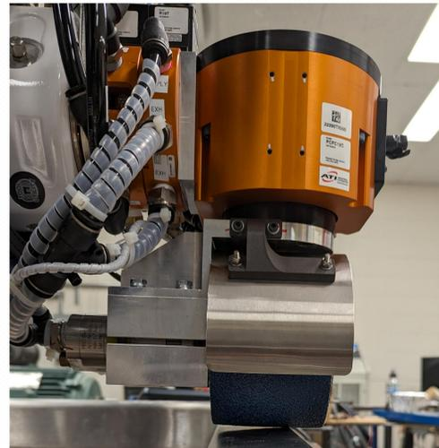
Figure 2: Roue de sablage
