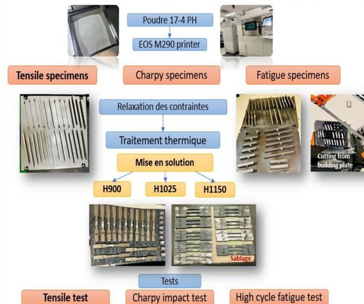
Figure 2: Diagramme détaillant la méthodologie adoptée.
