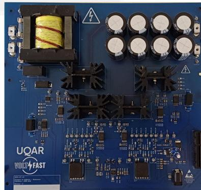
Figure 1 : Redresseur de chargeur de batterie
