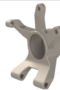
Figure 4 – Knuckle arrière imprimé en acier
