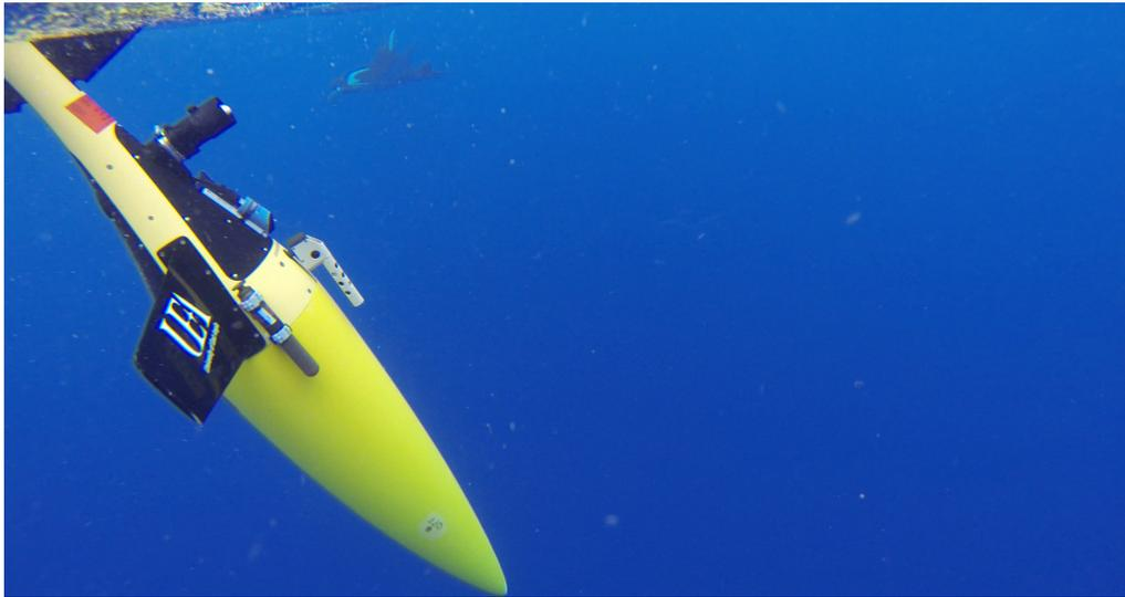
Figure 1: Un planeur sous-marin (*glider*) équipé d'un hydrophone attire la curiosité d'une raie Manta.
